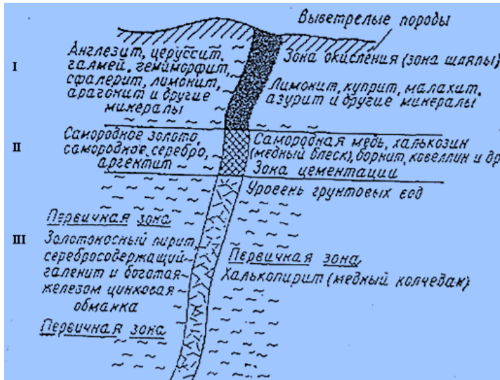
Рис.49. Схема окисления сульфидного месторождения: I-зона окисления; II-зона вторичного сульфидного обогащения (зона цементации); III-зона первичных руд
